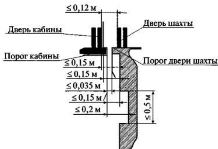
Рис. 3. Расстояния между элементами кабины и шахты
